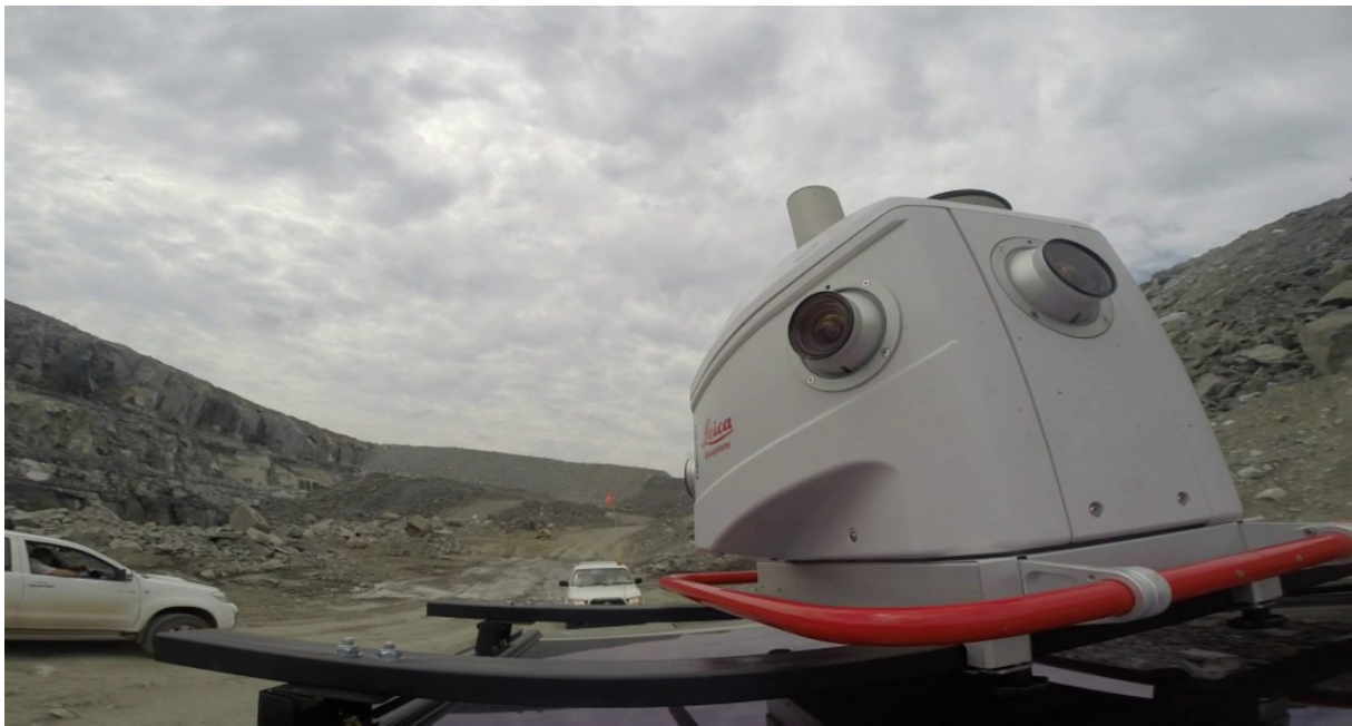
2. ábra. Mobil térképező rendszer bányafelmérés közben
