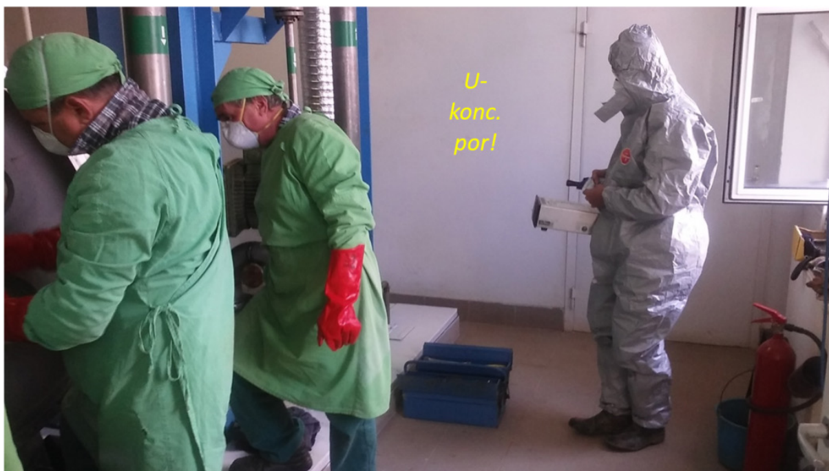
3. ábra. Urán koncentrátum por csomagolása és a munka dozimetriai ellenőrzése
