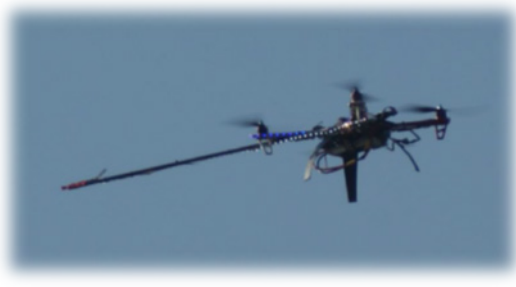
1. ábra. A Bonn Hungary pilótanélküli repülőgépe Vaisala rádiószondával és Vaisala HMP-45 szenzorral (bal oldal) és az Ostwestfalen-Lippéből (Németország) érkezett kvadrokopter a műszertartó konzollal (jobb oldal).
